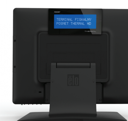
Wyświetlacz podwieszany Terminala fiskalnego Thermal HD, zamontowany na tylnej obudowie monitora dotykowego
